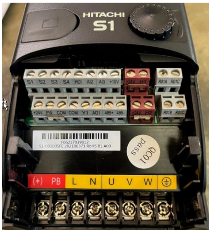
Fig 4.18 Schéma de câblage du circuit de commande (0.4–2.2kW)
