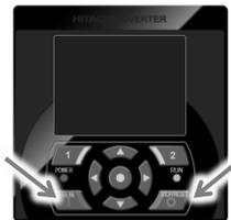
Dans le cas de AA111 = 00, réglez le démarrage/arrêt à partir de la borne FW/RV.
