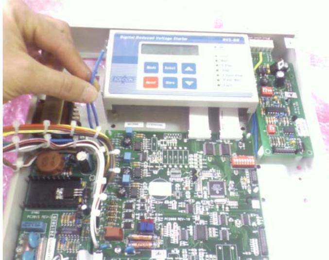
5. Enlever les protections d'isolation sur les bornes 11 et 12 du transformateur et souder les fils bleus à la place sans oublier la gaine thermo-rétractable pour l'isolation de la soudure
